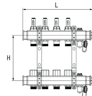
Расход теплоносителя при скорости течения 0,4 м/с – 1,53 м³/час, тепловой поток при T=50 Δt=10 K<17,5 kW
