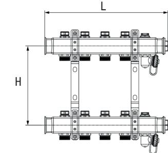
Расход теплоносителя при скорости течения 0,4 м/с – 1,695 м<sup>3</sup>/час, тепловой поток при T=70 Δt=20 K≤38,5 kW.
